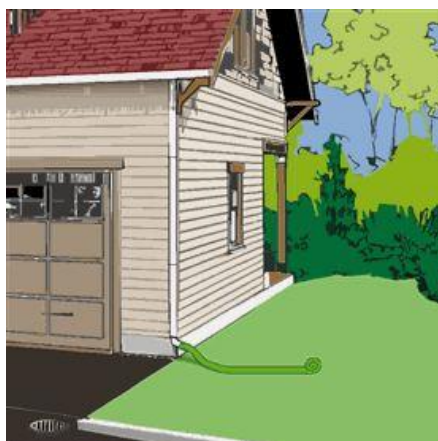
Utilisez un tuyau flexible. C'est une solution pratique car le tuyau n'encombre pas le terrain quand il ne pleut pas.
