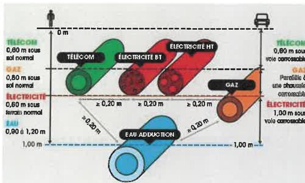
Les canalisations, quel qu'en soit le matériau, seront posées parfaitement alignées sur un lit de pose normal, qui sera constitué sur toute la largeur de la fouille par une couche de sable de dix centimètres (10 cm) d'épaisseur minimale sous la génératrice inférieure du tuyau et qui sera mise en œuvre avant la pose de la canalisation et enrobées en sable, jusqu'à vingt centimètres (20 cm) au-dessus de la génératrice supérieure du tuyau (le sable de mer lavé est interdit).
